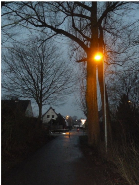
Beeinträchtigung der Ausleuchtung der Querungsstelle
